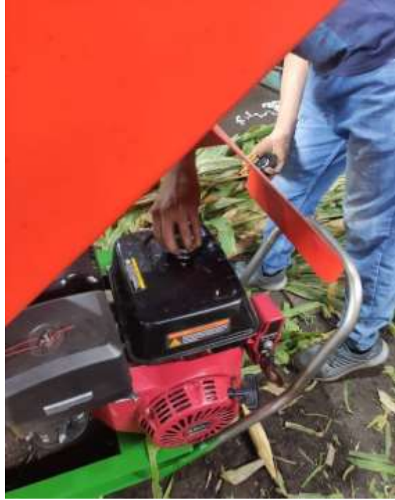
4. Revisión del tanque de gasolina
