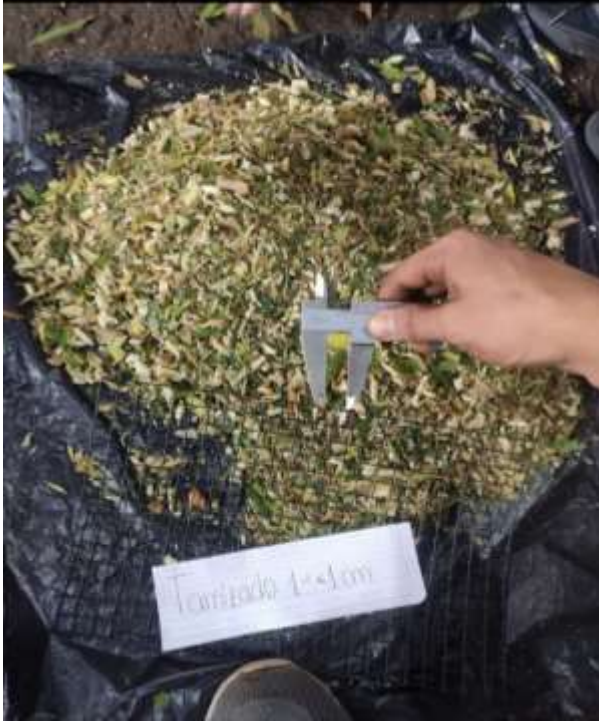
3. Clasificación y medición del tamaño de las partículas del picado de las muestras
