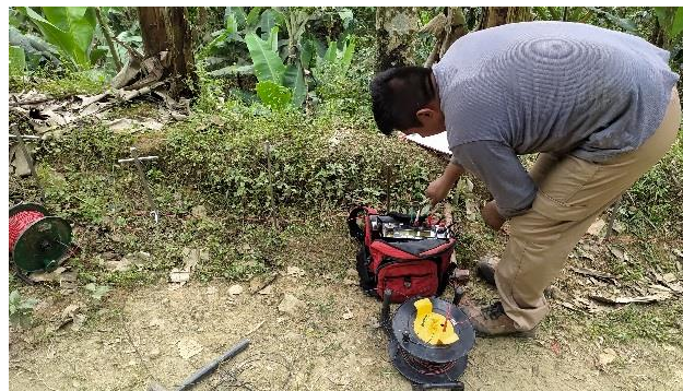
Figura 17 Aplicación en campo de sondeo eléctrico vertical.
