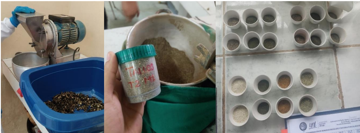
Figura 11. Homogenización de las muestras, proceso de molienda y pesaje para la obtención de cenizas
