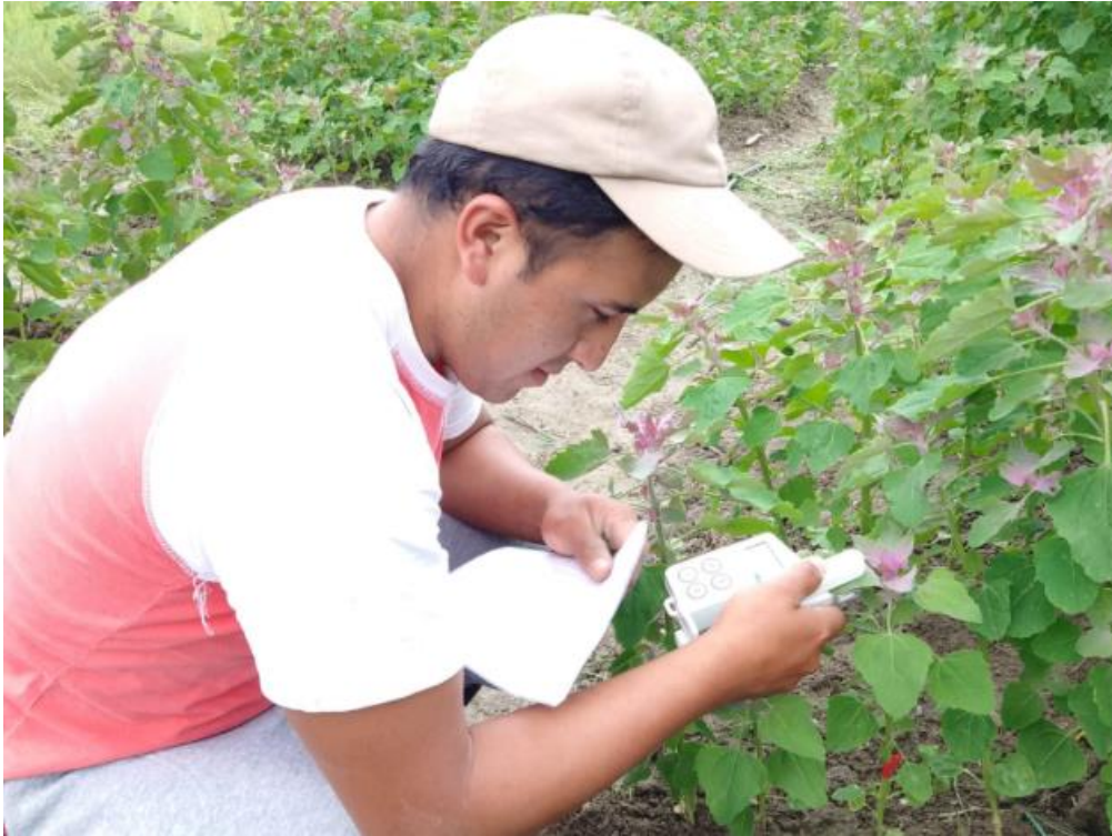
Anexo 3. Medición del contenido de clorofila con el equipo Spad Mimolta 502.
