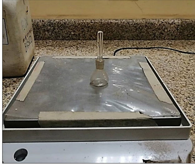
Figura 14. Método de picnómetro para determinar la gravedad específica.
