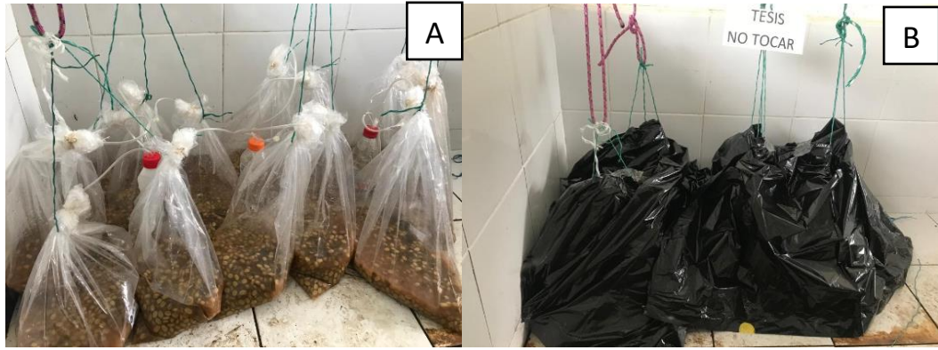
Anexo 1. figura 11. A) Colocación de las mangueras de venoclisis en cada una de las fundas. B) Cubrimiento de los biorreactores con fundas negras para propiciar la fermentación adecuadamente.
