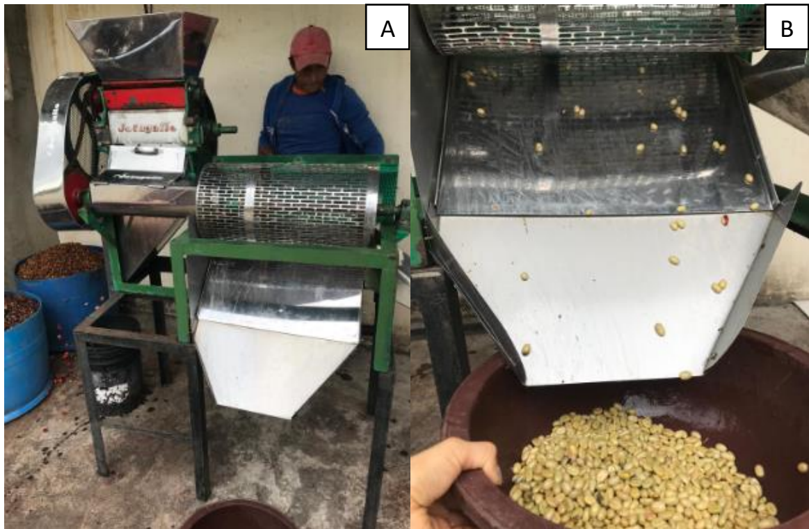
Anexo 1. figura 6. A) Modelo de despulpadora utilizada. B) Cerezas de café despulpadas
