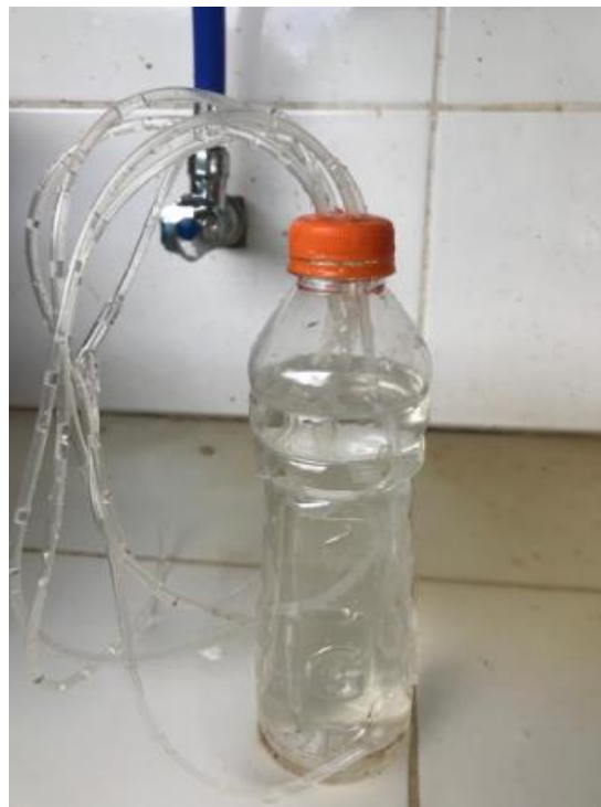
Anexo 1. figura 8. Adecuación de las botellas utilizadas como trampas de oxígeno.
