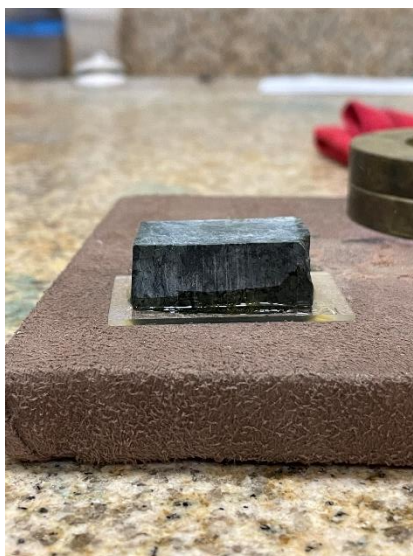
Figura 20 Briqueta pegada al portaobjetos
