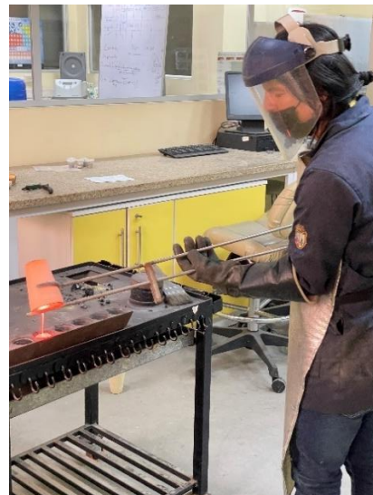
Figura 14 Vertido de la fundición
