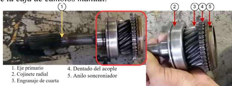
Figura 24 Eje primario de la caja de cambios manual.
