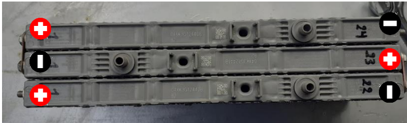
Figura 42 Módulos conectados en serie
