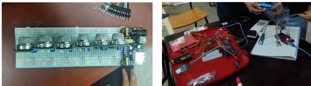
Figura 3. Pre calentamiento de sensores y ensamble de circuitos.
