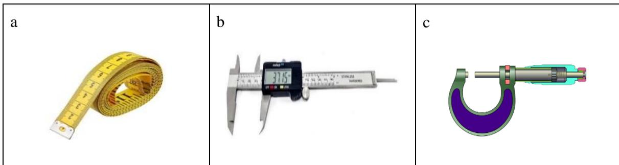
**Figura 1.** Instrumentos para medición de diámetros
