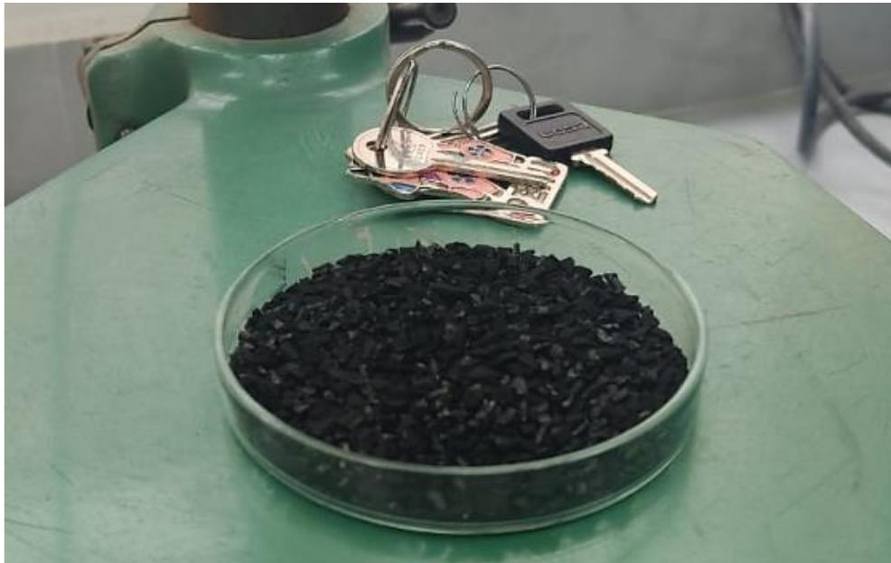
**Figura 6.** Carbón activado, tamaño 1-3 mm,
