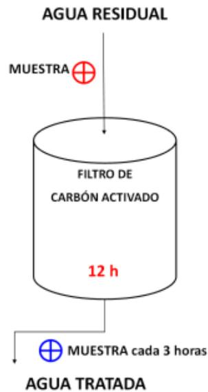
**Figura 13.** Diagrama de flujo filtración estática
