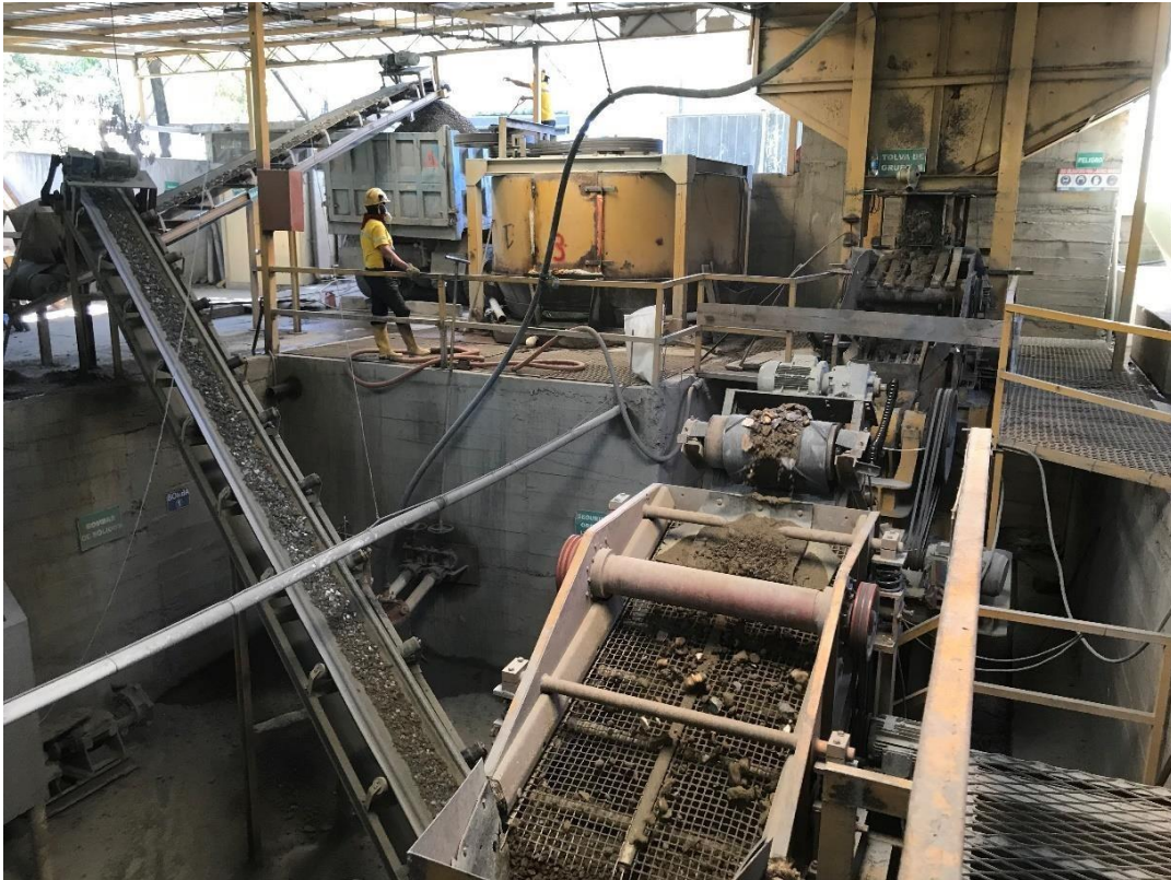
Figura 15. Secuencia de quipos de Trituración de la Plata de Beneficio y esquemas en circuitos cerrados.
