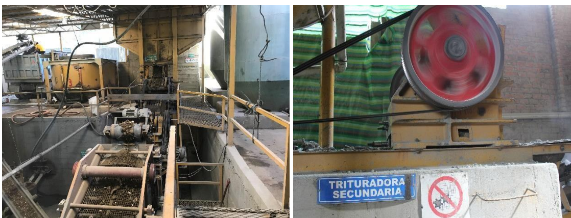
Figura 16. Equipos de trituración primaria y secundaria de la Planta de Beneficio.
