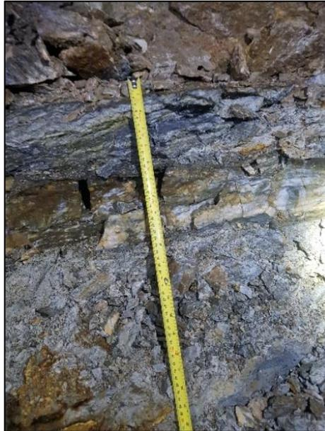
**Figura 7.** Medición de la potencia de la veta
