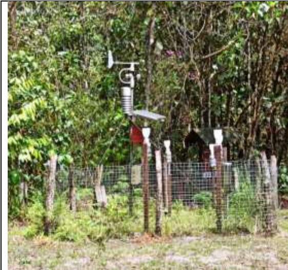
Estación meteorológica tiene sensores los cuales miden temperatura, humedad.
