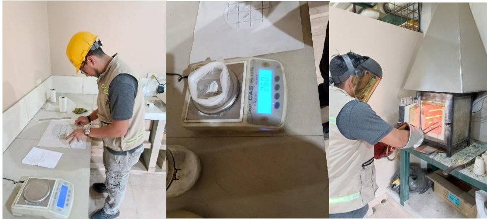
Figura 14. Procedimiento del Ensayo al fuego
