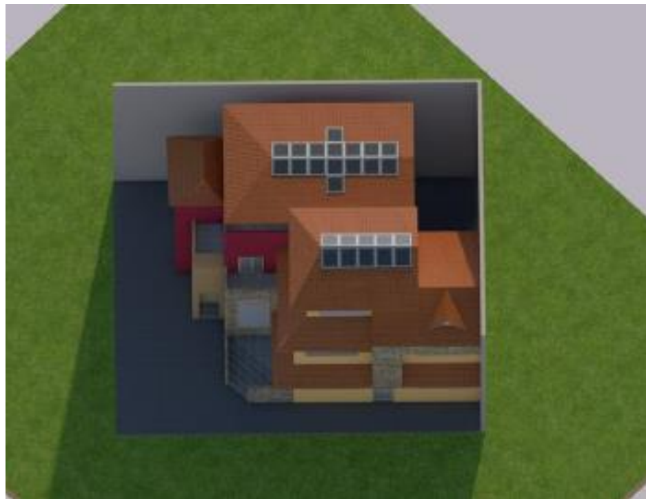
Figura 37. Distribución de los paneles en la cubierta con dirección hacia la izquierda.
