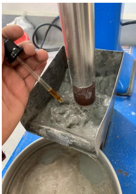
Figura 28. Adición del colector Xantato Isopropílico de Sodio (Z-11)
