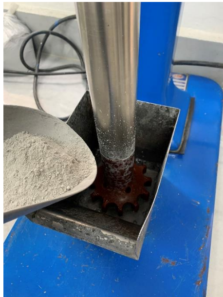
Figura 26. Masa sólida de mineral agregada a la celda.
