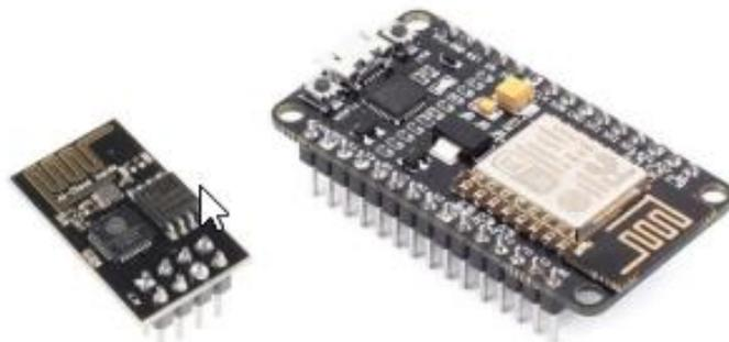
**Fig. 4.** Modulo ESP-01 y NodeMCU
