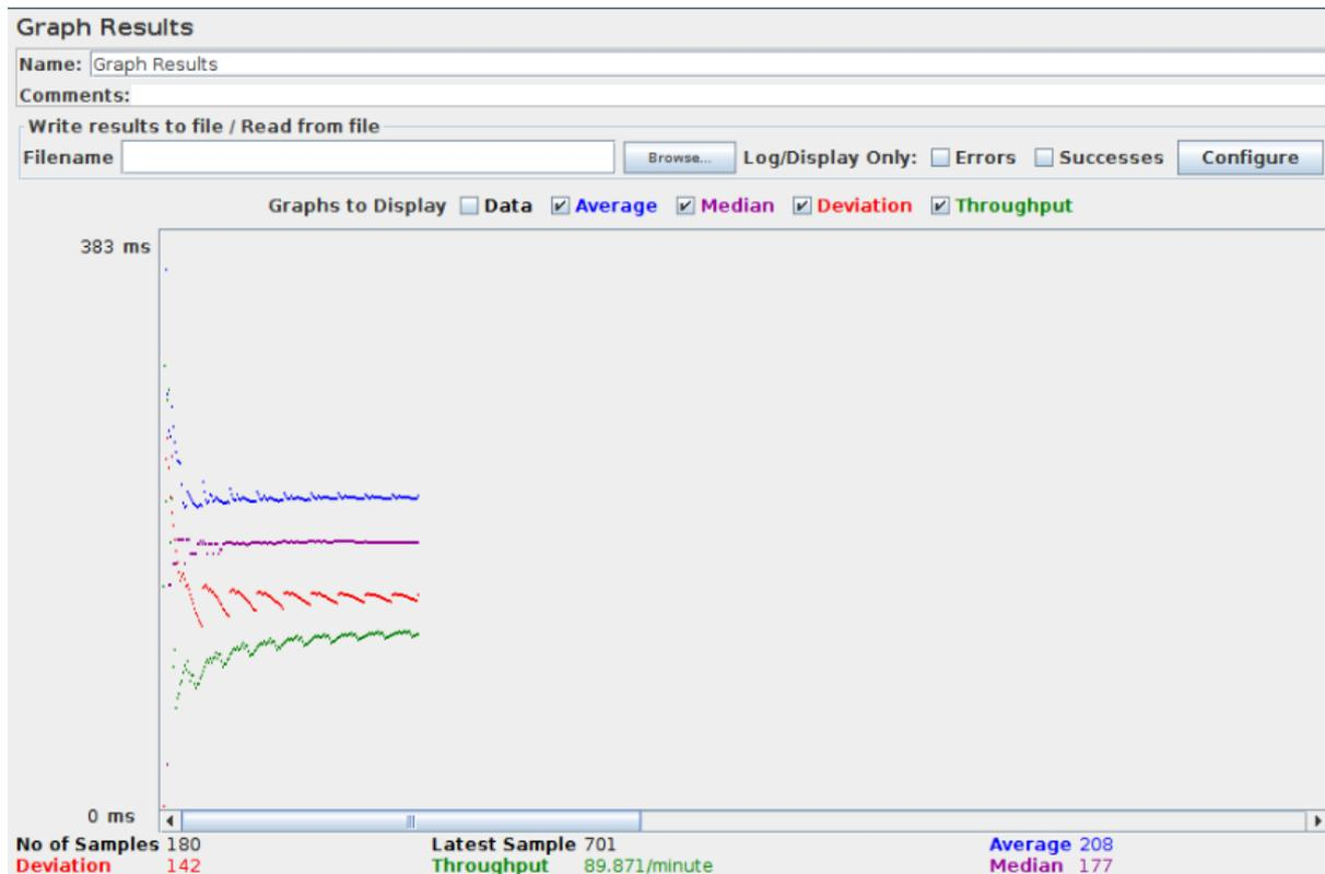
**Fig. 4.** Ejemplo de resultado de prueba de carga con JMeter
