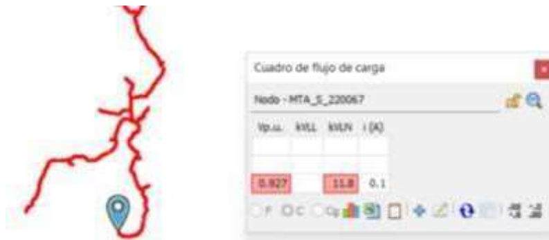
Figura 6. Resultados del flujo de carga en el punto más alejado del A/P, para el estado actual
