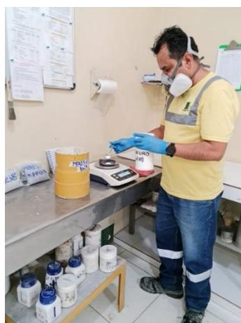
**Nota:** la imagen representa el pesaje y adición de agente lixivante NaCN, al reactor para la agitación.
