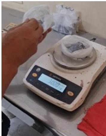
**Nota:** La imagen representa el pesaje de los 30 gr. De mineral pulverizado malla -200 que pasara al proceso de ensayo al fuego.
