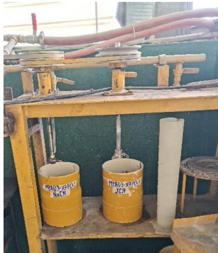
**Nota:** La imagen representa a los agitadores mecánicos y los reactores cargados con la solución lixivante para el proceso de agitación.
