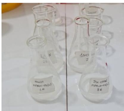
**Nota:** La imagen representa las alícuotas tomadas a intervalos de 2 horas de la agitación mecánica en el proceso de lixiviación con los agentes lixiviantes NaCN y Jinchan.
