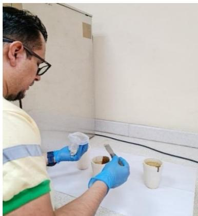
**Nota:** La imagen representa el agregado de: muestra mineral, agentes oxidantes como ( $\text{KNO}_3$ ), y fundentes el cual nos ayudó a obtener una buena carga de fusión por las muestras con presencia de sulfuros.
