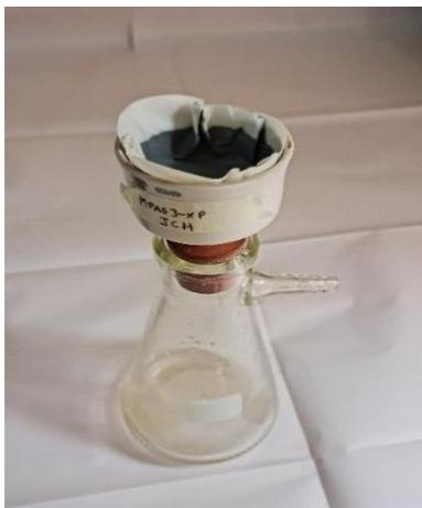
**Nota:** La imagen representa la solución lixivante extraída y filtrada del reactor, de 20ml, que pasará una parte de 10 ml para el análisis de consumo de  $\text{CN}^-$  (cianuro libre) y Jinchuan la otra parte de 10ml servirá para la cinética de lixiviación.
