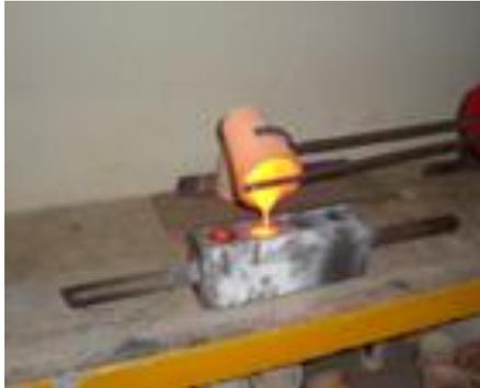
**Nota:** La imagen representa la colocación del contenido fundido del crisol, en la lingotera.
