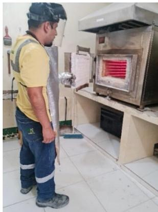
**Nota:** La imagen representa el proceso de copelación en donde se abre la puerta del horno para el ingreso de oxígeno que servirá para el enfriamiento.
