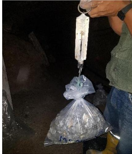
**Nota:** La imagen representa el pesaje con la balanza romana de aproximadamente 6kg de muestra mineral para ser transportada al laboratorio metalúrgico.
