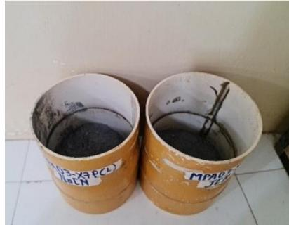
**Nota:** La imagen representa a los reactores cargados con el mineral pulverizado y cal para una concentración de sólidos del 33.33%.
