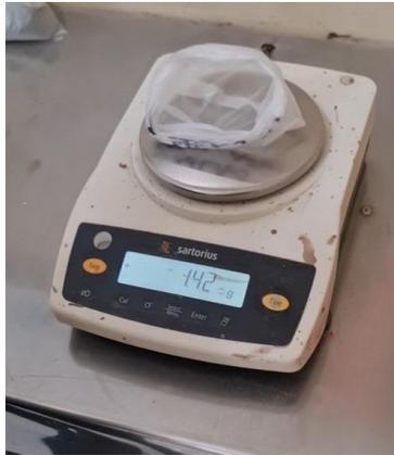
**Nota:** La imagen representa el encerado de la balanza y la funda donde se almaceno mineral pulverizado, para el ensayo al fuego
