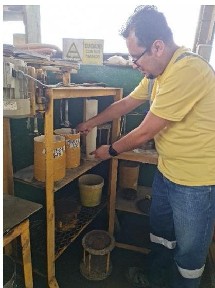
Los parámetros que se consideraron en el proceso de lixiviación son los siguientes: porcentaje de sólidos; granulometría; concentración de cianuro de sodio y Jinchan mg/l; tiempos de reacción; la temperatura fue controlada con un dispositivo multiparámetros a una temperatura entre los 21 y 23 °C o temperatura ambiente; pH; velocidad de agitación mecánica.
