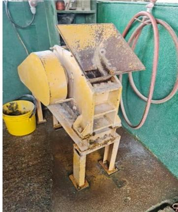
**Nota:** La imagen representa la trituradora primaria de mandíbulas en donde se procedió hacer la reducción de las muestras provenientes de mina a una malla 10.
