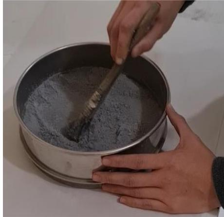
**Nota:** La imagen representa la preparación del material por la malla -200, para los ensayos metalúrgicos.
