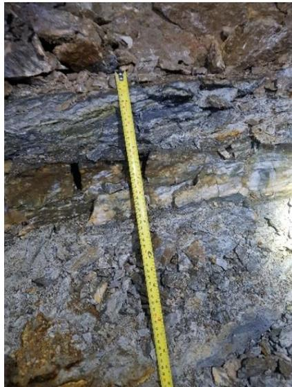
**Nota:** La imagen representa, el registro y medición del espesor de la veta en el sector de muestreo.
