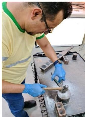
**Figura 42.** Regulo de plomo en forma de cubo para copelación.
