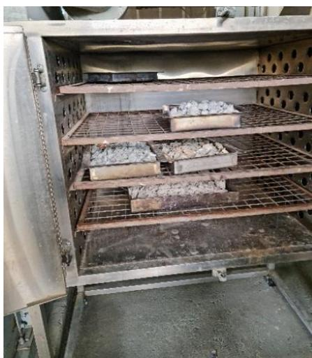
**Nota:** La imagen representa el ingreso de las muestras en las bandejas para el secado en el horno a una temperatura de 100°C.
