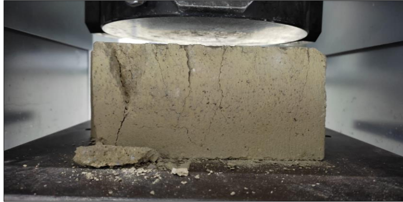
Figura 6. Ensayo a la compresión de adoquines sin relave minero. Nota. Adaptado de laboratorio de mecánica de suelos, resistencia de materiales y asfaltos , Universidad Técnica Particular de Loja, 2023.
