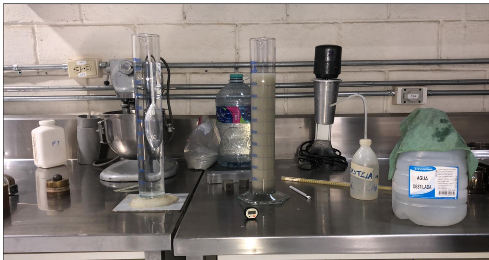
Figura 9. Insumos utilizados y aplicación del ensayo de densidades por hidrometría para determinar la granulometría del relave.
