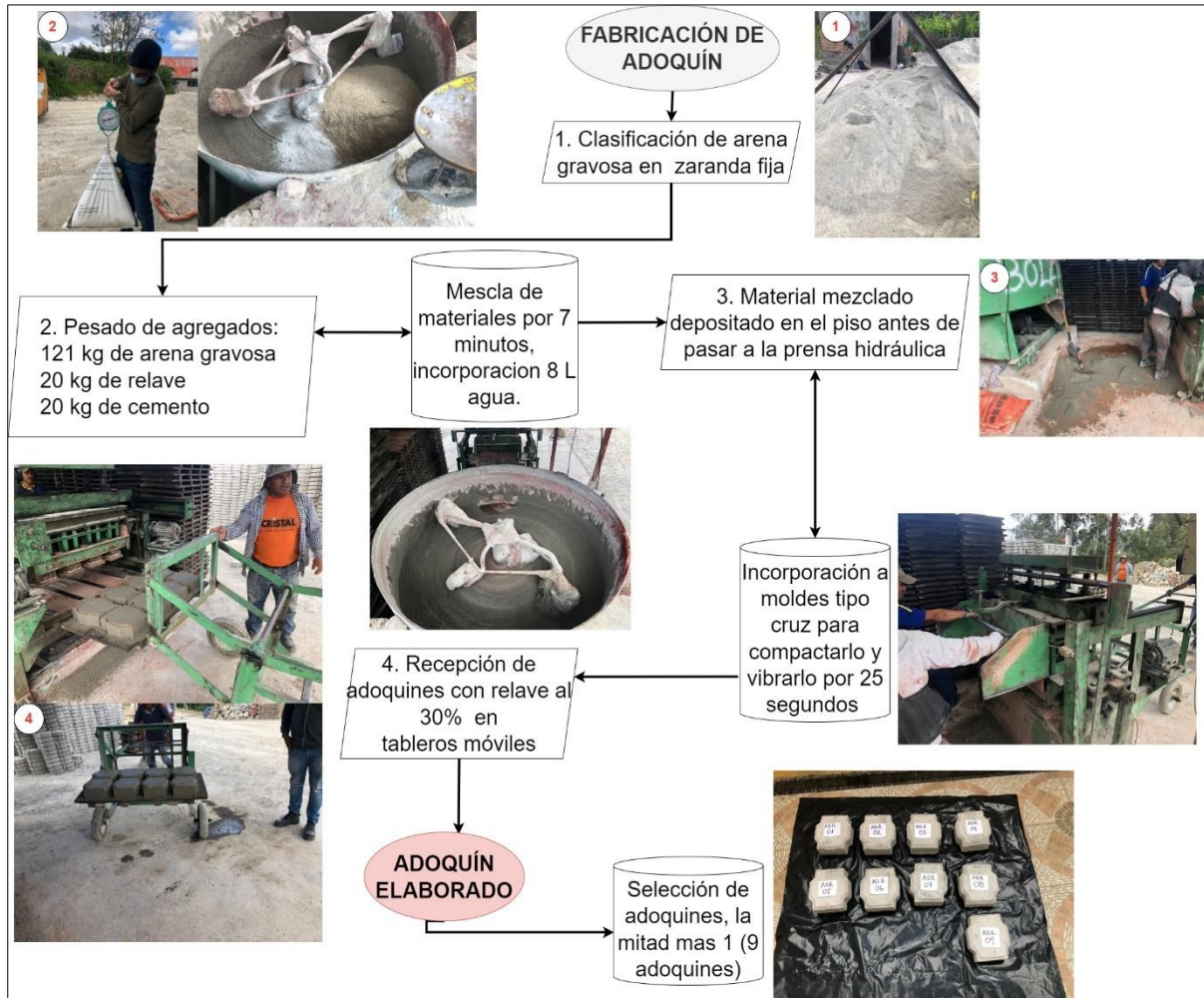
Figura 5. Diagrama de flujo, procedimiento para obtener adoquines con 30% de relave en su composición.
