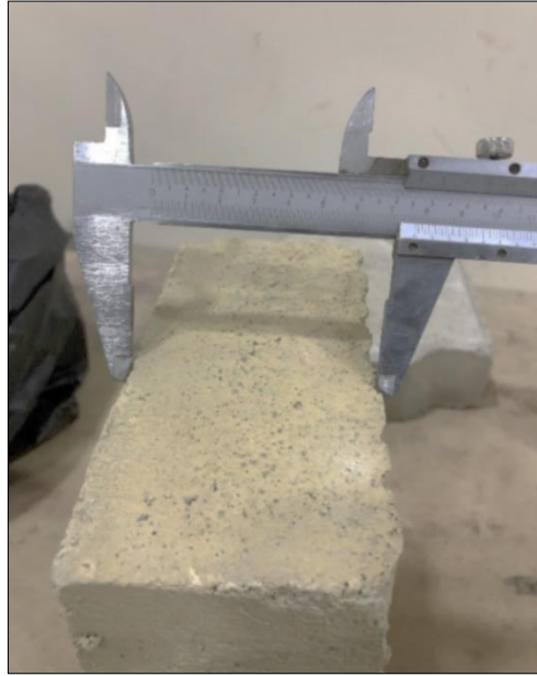
Figura 8. Medición de espesores en adoquines con relave. Nota. Adaptado de laboratorio de mecánica de suelos, resistencia de materiales y asfaltos , Universidad Técnica Particular de Loja, 2023.
