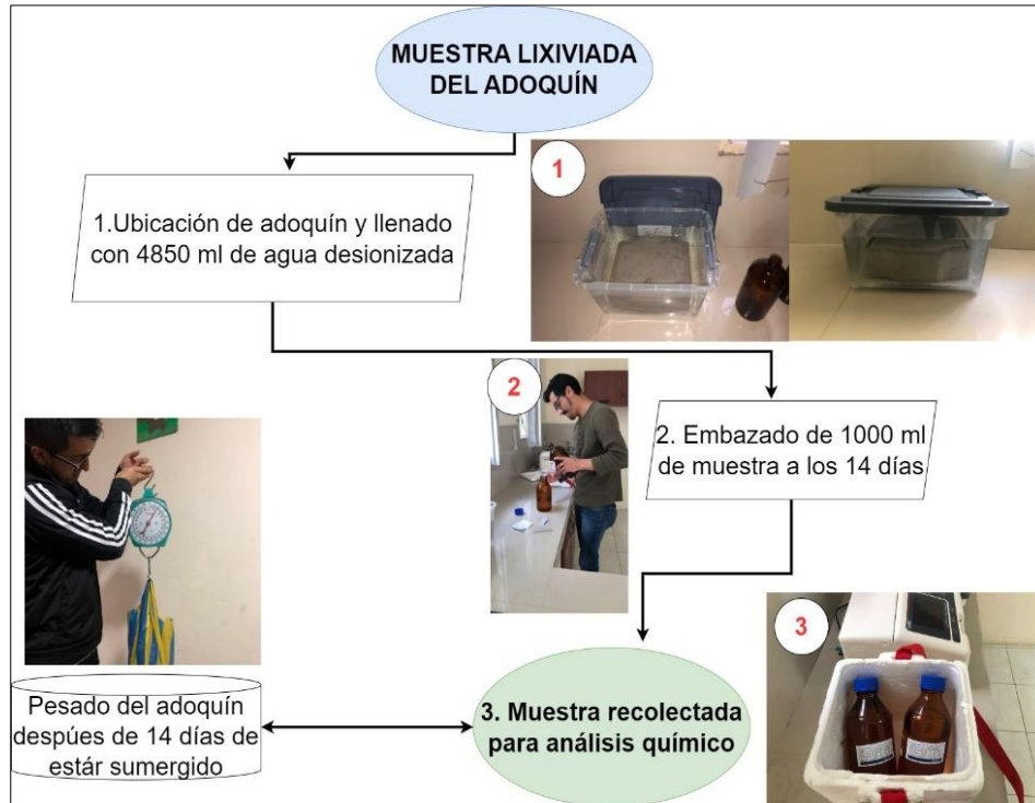
Figura 11. Diagrama de flujo, preparación de muestra lixiviada desde el adoquín.
