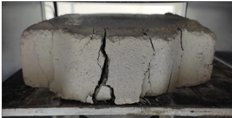
Figura 7. Ensayo a la compresión de adoquines con 30% de relave en su composición. Nota. Adaptado de laboratorio de mecánica de suelos, resistencia de materiales y asfaltos , Universidad Técnica Particular de Loja, 2023.
