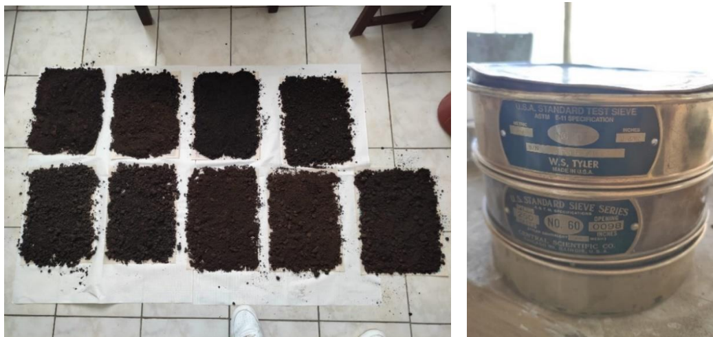
Anexo 6. Proceso de secado y tamizado de las muestras de suelo en laboratorio.
