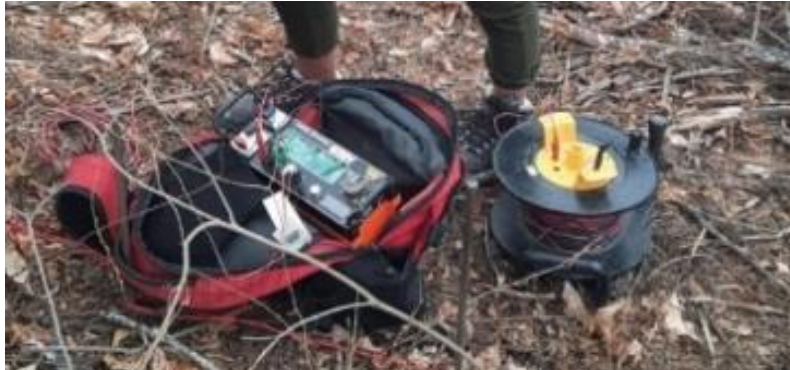
Figura 16. Obtención de datos del SEV con en Resistivímetro SAS 4000.
