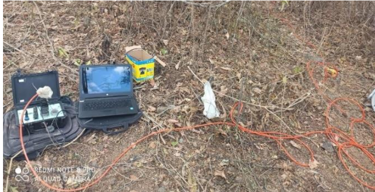
Figura 18. Equipo Sísmica PASI GEA24 para exploración geofísica. Nota: Caraguay D. (2023)
