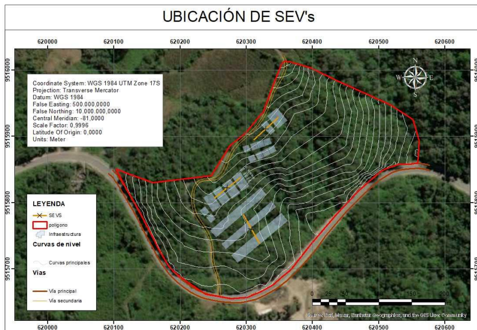
Figura 47. Disposición de los Sondeos Eléctricos Verticales.
