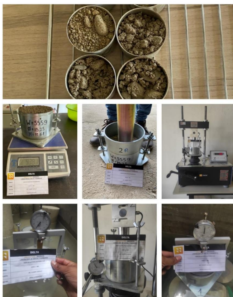
Figura 22. Ensayo Proctor y CBR en el laboratorio de suelos y pavimentos DELTA Fuente: Autor, (2022)
