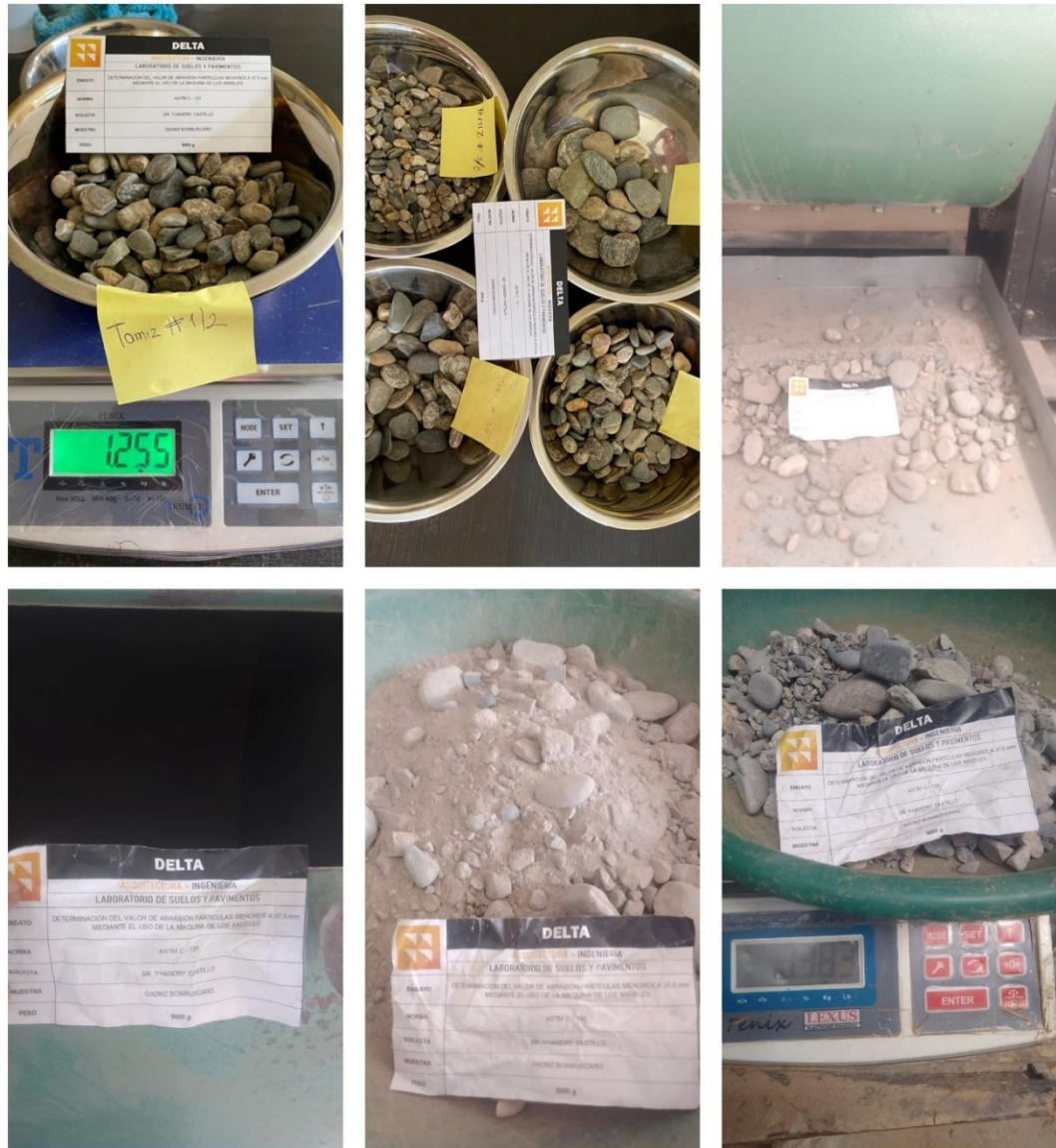
Figura 23. Ensayo de Abrasión en el Laboratorio de Suelos y Pavimentos DELTA Fuente: Autor, (2022)
