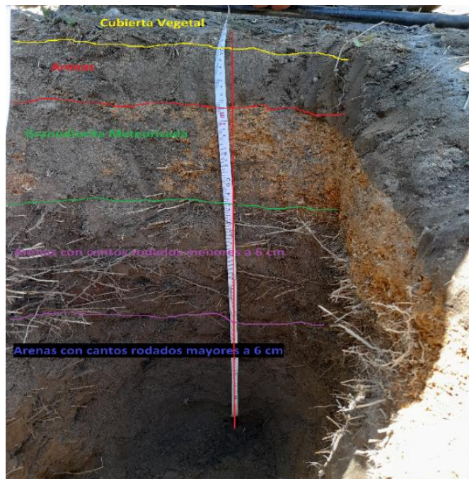
Figura 18. Calicata 3 Fuente: Autor (2022)
