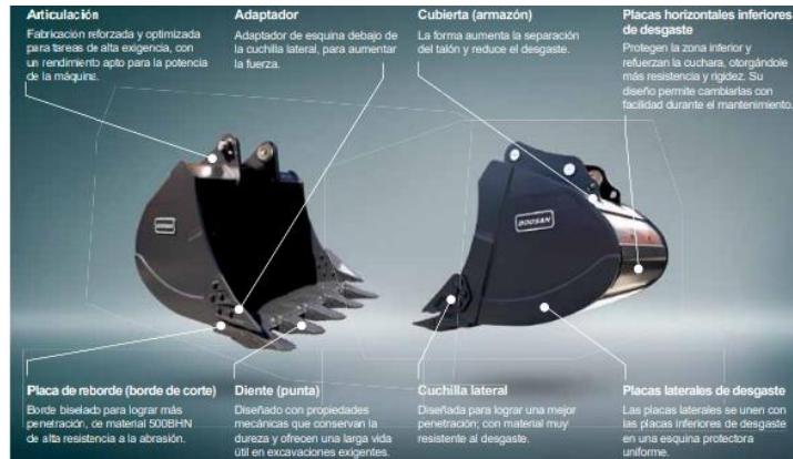
Figura 31. Cucharón para roca dura DOOSAN capacidad 2 m 3 Fuente: (Doosan, 2022)
