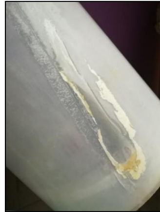
Figura 19. Suelda en frío (fisura en tanque). Fuente. el autor.
