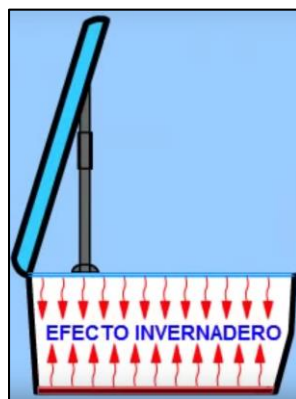
Figura 6. Efecto invernadero producido dentro del horno.
