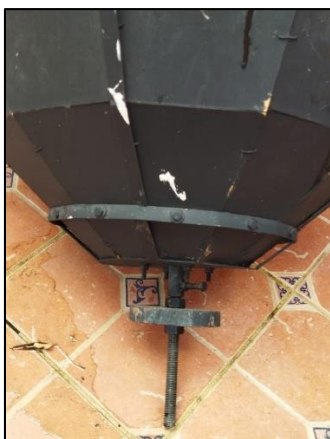
Figura 29. Sistema de contrapeso en la base del horno solar.
