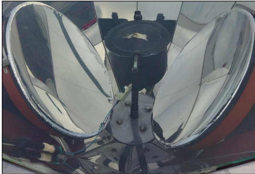
Figura 41. Concentradores ubicados en el horno solar.
