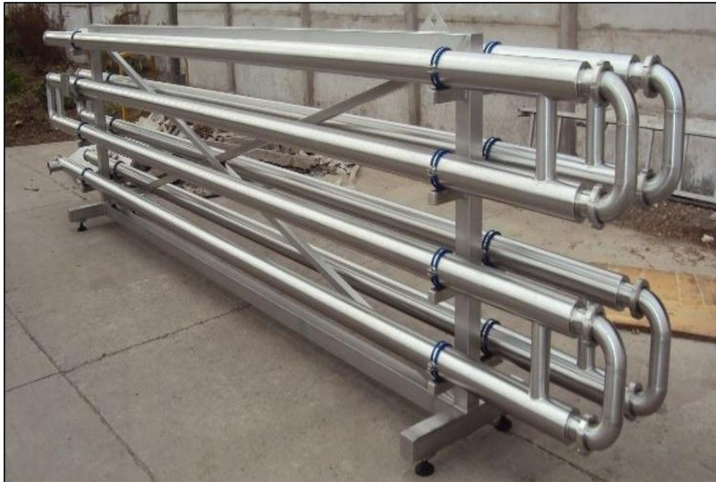
**Figura 4.** *Intercambiador de calor de tubos concéntricos industrial.*
