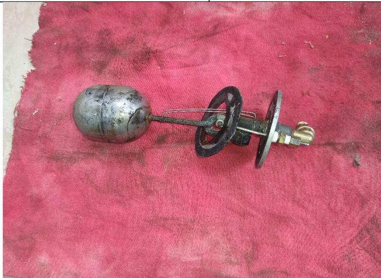
Bombas de agua, trampas de vapor y boya con oxido y en mal estado
