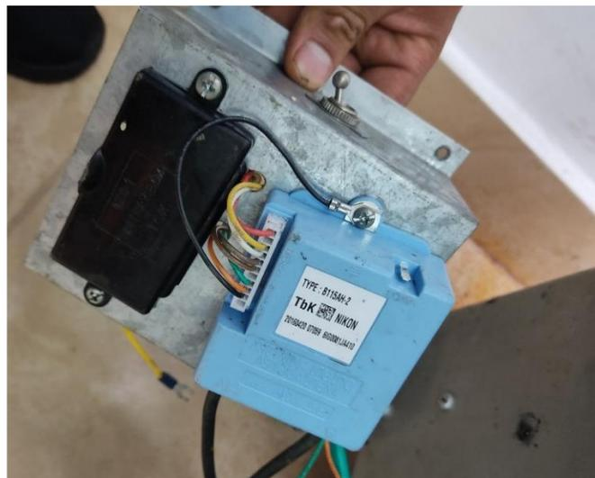
**Figura 27.** Sustitución del módulo electrónico B115AH-2
