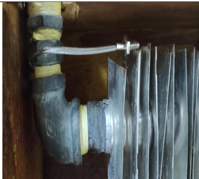
Ensamblaje de termocuplas a los intercambiadores de calor y colocación de conexión USB
