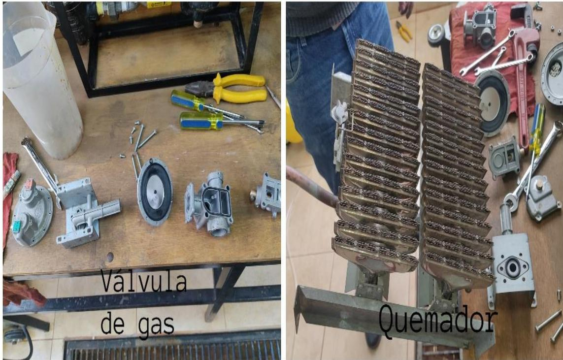
**Figura 28.** *Mantenimiento a las partes internas del calderín (quemador y válvula de gas)*
