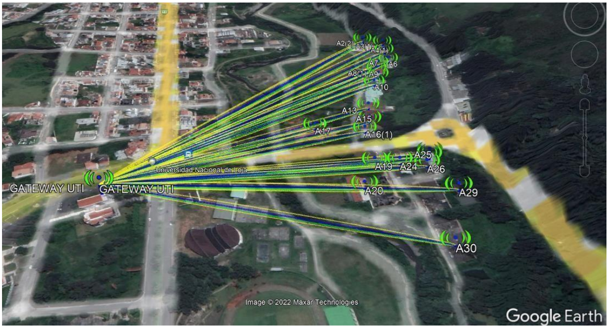
Figura 23. Enlace LoRaWAN Nodos energéticos, UNL Matriz Barrio La Argelia.
