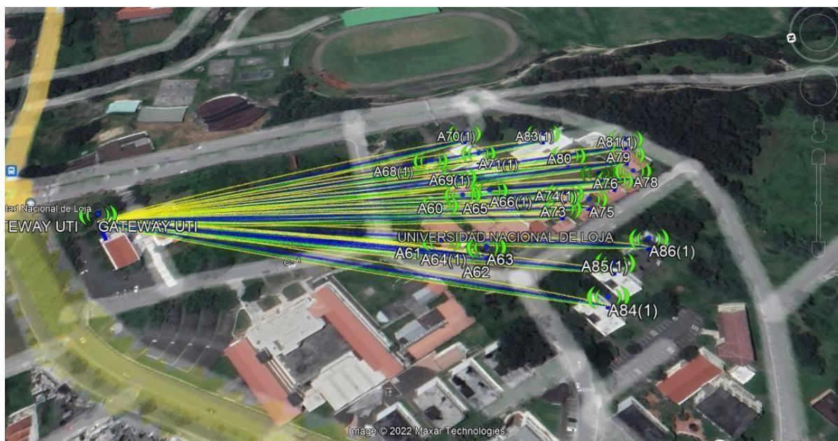
Figura 21. Enlace LoRaWAN Nodos energéticos, UNL Matriz Barrio La Argelia.
