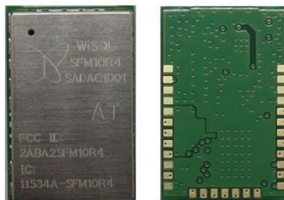
Figura 36. Modulo Wisol RC4 para Latinoamérica Sigfox.
