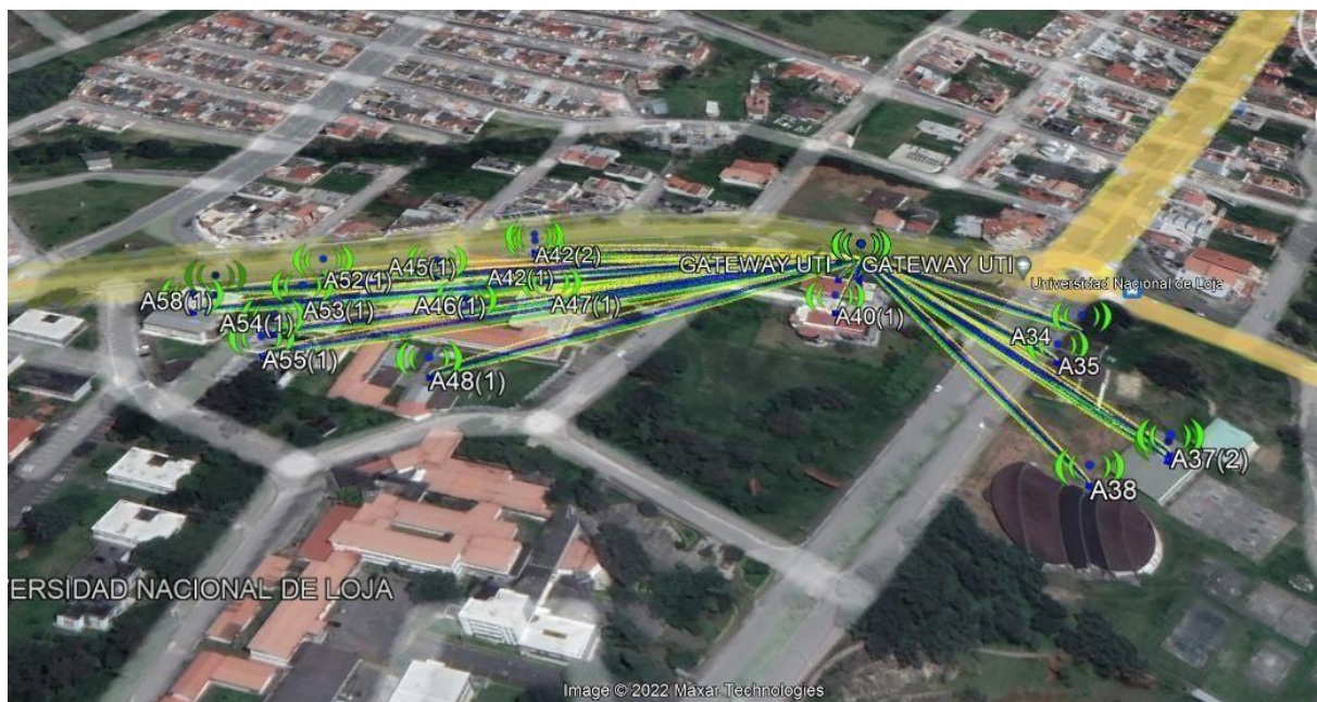
Figura 22. Enlace LoRaWAN Nodos energéticos, UNL Matriz Barrio La Argelia.
