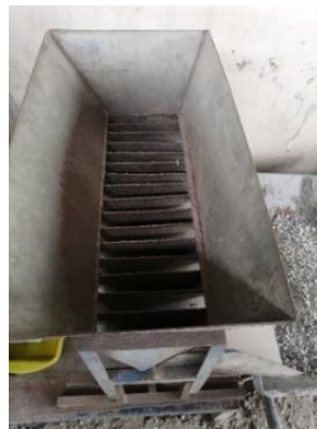
Figura 14: Cuarteador de dos porciones Nota. Elaborado por la autora
