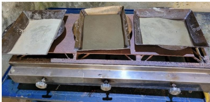
Figura 23: Secado de las muestras de molienda Nota. Elaborado por la autora
