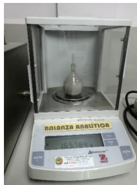
Figura 16: Ensayo de densidad
