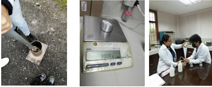
Figura 15: Ensayo de densidad
