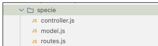
Figura 16. Estructura de archivos de un servicio API-REST
