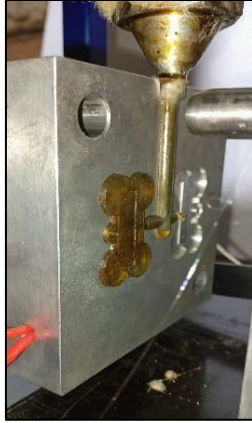
Figura 98. Extracción de una pieza moldeada.
