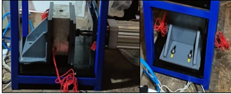
Figura 89. Calibración del molde y ajuste de la placa fija ajustable.
