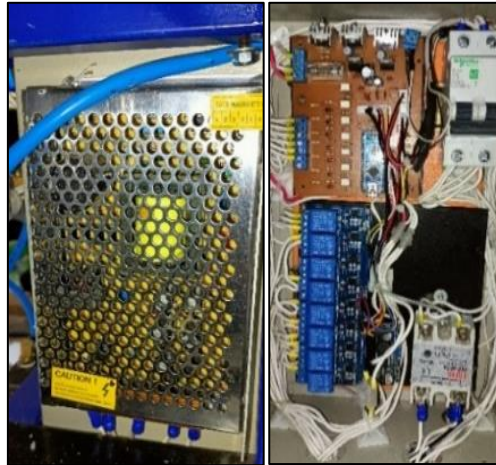
Figura 92. Disposición del sistema de alimentación y control.
