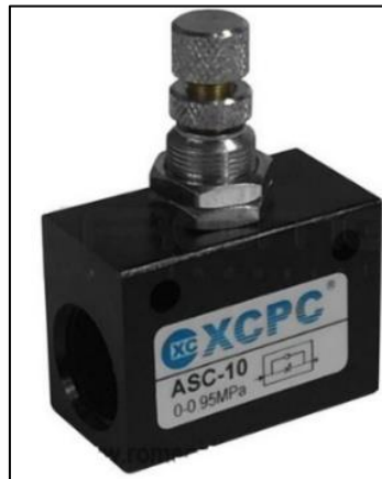
Figura 54. Válvula reguladora de flujo tipo block con check ajustable unidireccional.
