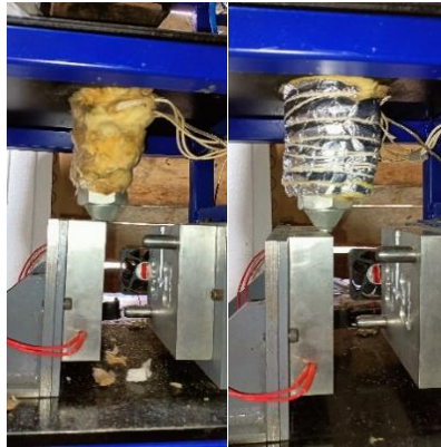
Figura 90. Aislamiento del barril de inyección con lana de vidrio.
