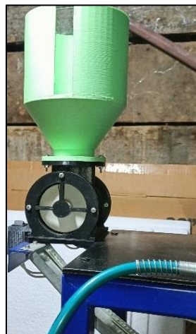
Figura 91. Ensamblaje del sistema de alimentación y almacenamiento del material.
