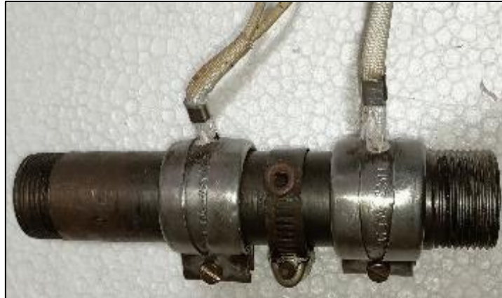
Figura 85. Montaje del sistema de calefacción y censado en el barril de inyección.
