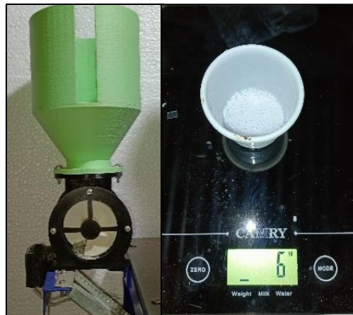
Figura 101. Medición de la cantidad de material expulsado por el sistema de almacenamiento.
