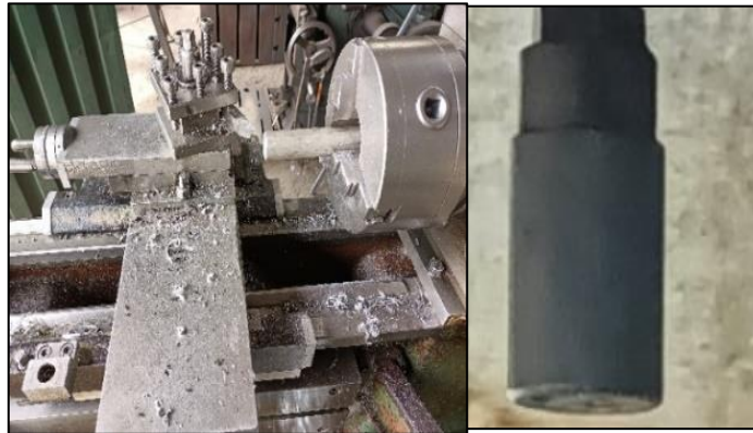
Figura 73. Mecanizado del émbolo de inyección.
