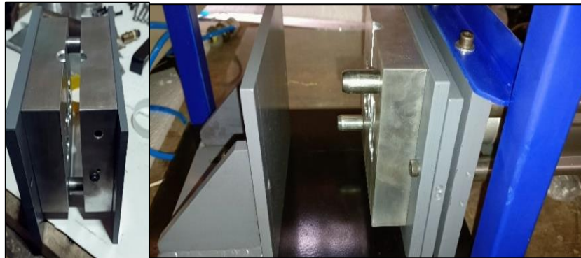
Figura 88. Montaje del molde en la unidad de cierre.
