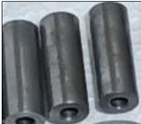
Figura 80. Separadores que conforman la unidad de cierre.
