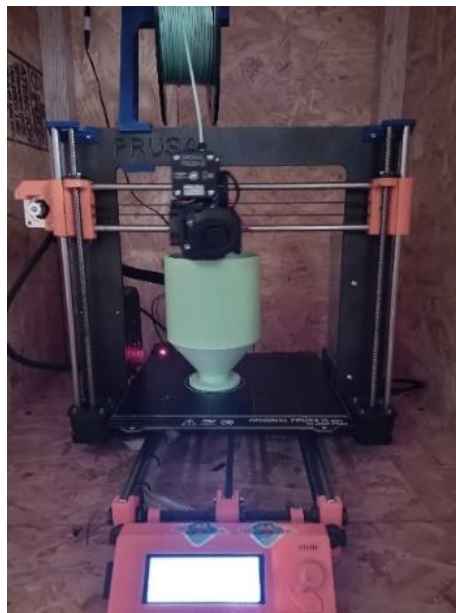
Figura 76. Fabricación de la tolva de alimentación.
