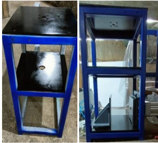
Figura 83. Montaje de las planchas en la estructura.
