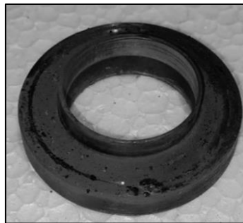
Figura 71. Buje una vez terminado el proceso de torneado.
