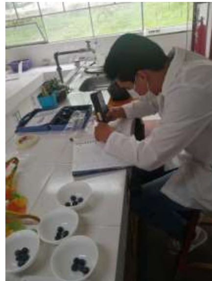
Figura 25. Toma de datos de firmeza del fruto con un penetrómetro.
