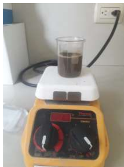
Figura 29. Colocación de muestras de suelo en el agitador.
