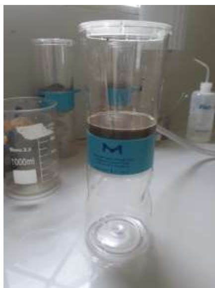
Figura 30. Filtrar la mezcla de suelo con agua.
