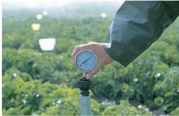
Figura 5. Medida de presión en la boquilla del aspersor usando un manómetro.
