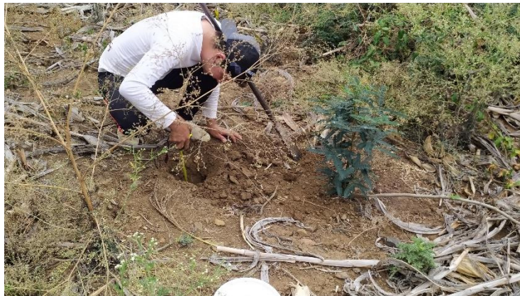
Figura 22. Toma de muestras de suelo del lugar de análisis.
