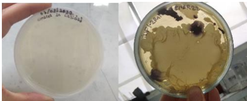
Figura 41. Controles: Izquierda-negativo, control de calidad que contuvo solo Agar con la finalidad de constatar contaminación o no del protocolo empleado, y derecha-positivo, control que contuvo una muestra directa para constatar el crecimiento bacteriano.
