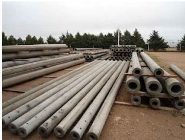
Ilustración 44: Postes de hormigón con estructura circular para redes eléctricas. | Fuente: [37]
