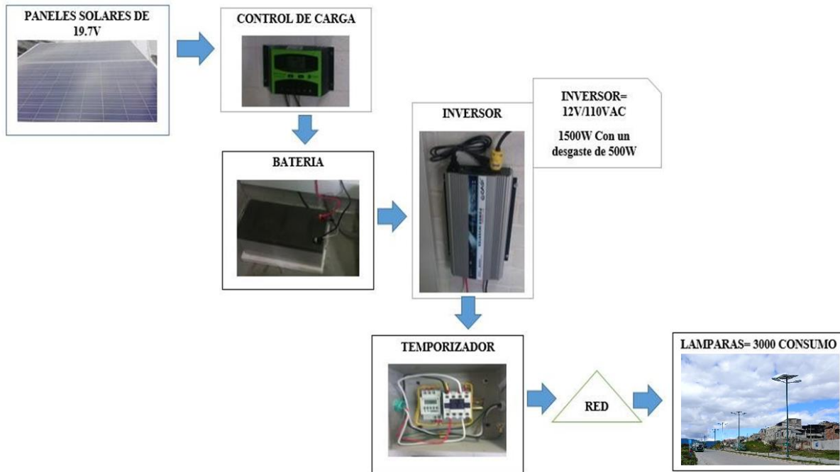
Ilustración 53: Funcionamiento sistema fotovoltaico. | Fuente: Autores
