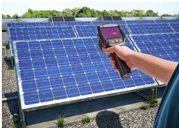
Ilustración 30: Comprobación de las celdas fotovoltaicas a través de una cámara térmica | Fuente: Guía de operación y mantenimiento de sistemas fotovoltaicos. Ministerio de energía. Gobierno de Chile [45].
