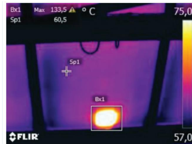
Ilustración 31: HotSpot presente en una celda fotovoltaica. | Fuente: Autores
