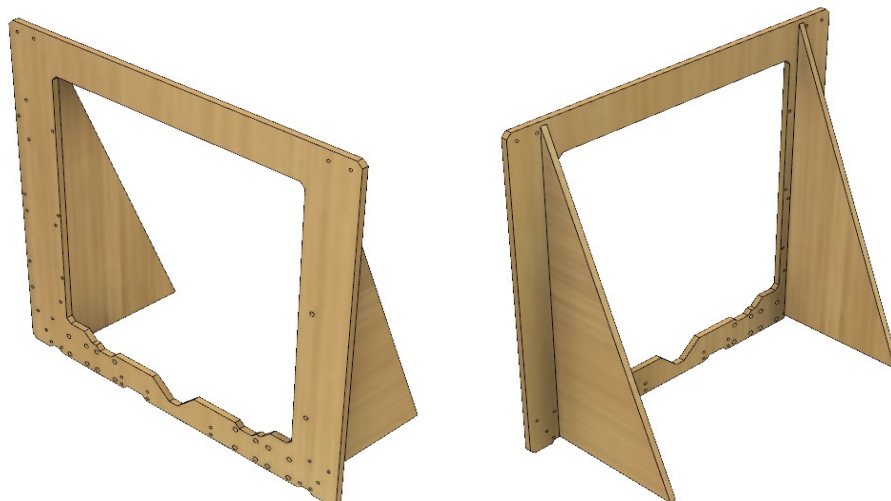
Figure 6-8. Marco de la impresora 3D
