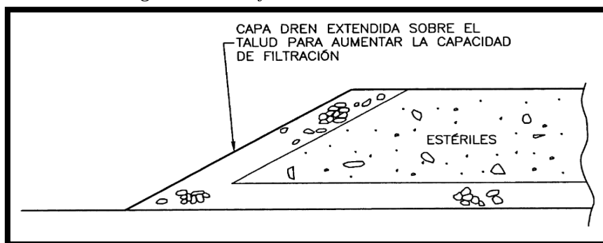
Figura 5. Drenaje del talud de la escombrera
