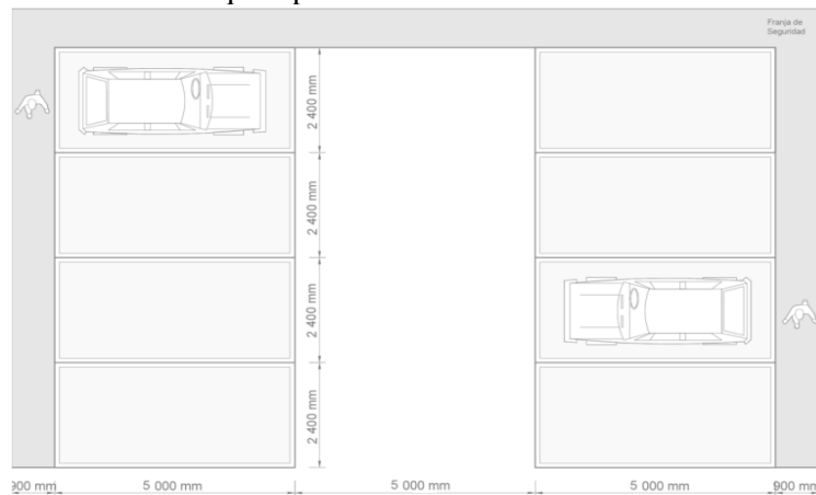
Figura 74. Área de circulación peatonal en estacionamientos.
