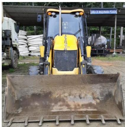
**Fotografía 20.** Retroexcavadora JCB (Modelo 3CX)
