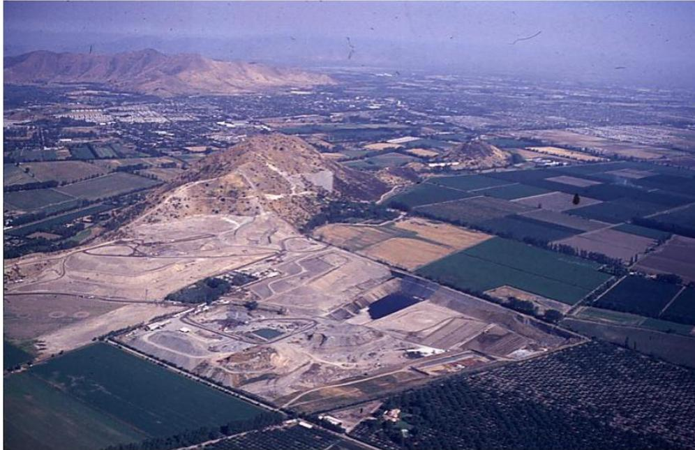
**Figura 6.** Extracción de agregados desde del abanico aluvial del río Maipo
