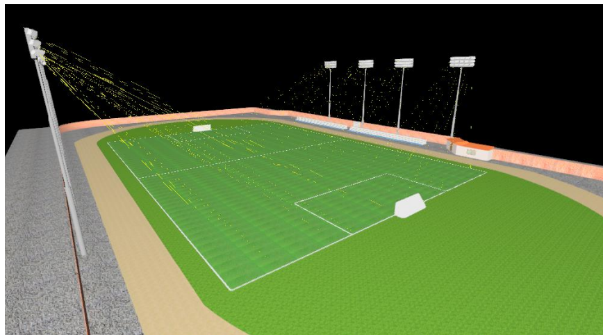
Figura 9. Direccionamiento de la luz de las luminarias
