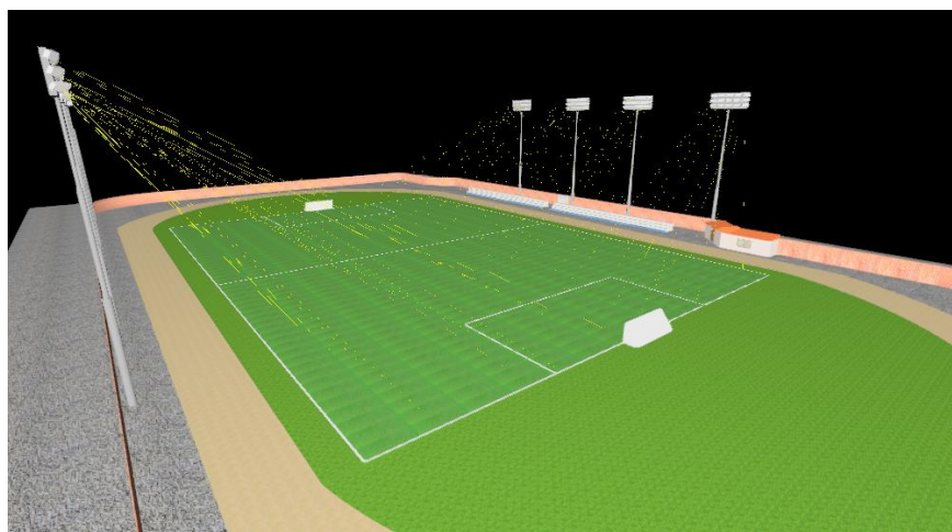
Figura 58. Direccionamiento de la luz de las luminarias
