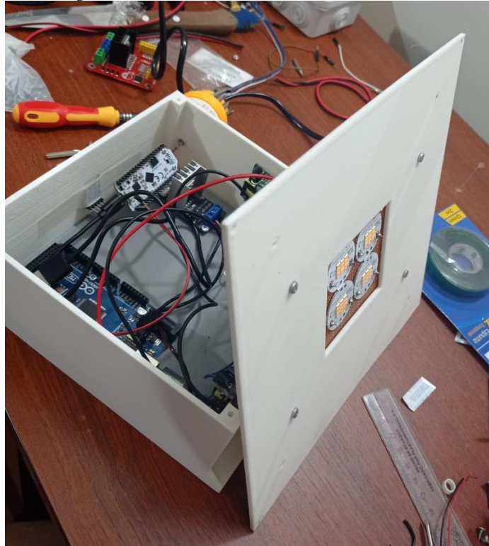
Figura 31 Ensamble de la lámpara inteligente
