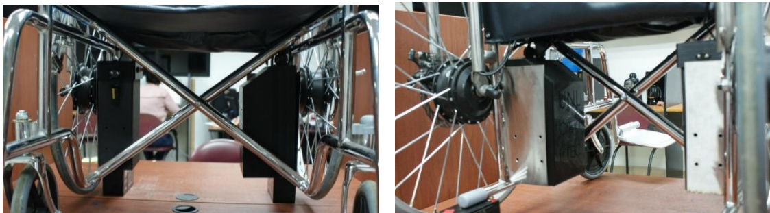
Figura 62. Ubicación final de la caja de alimentación y de control.
