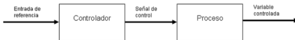
Figura 12. Diagrama de bloques de control de lazo abierto
