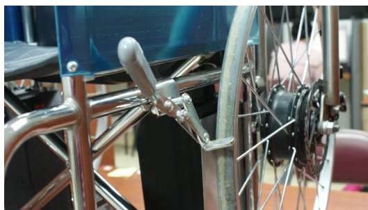
Figura 29. Frenos manuales implementados en la silla de ruedas.
