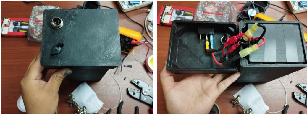
Figura 59. Resultado final del ensamble de la batería
