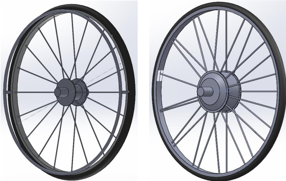
. a) Rueda existente en la silla de ruedas manual b) Rueda modificada para el prototipo
