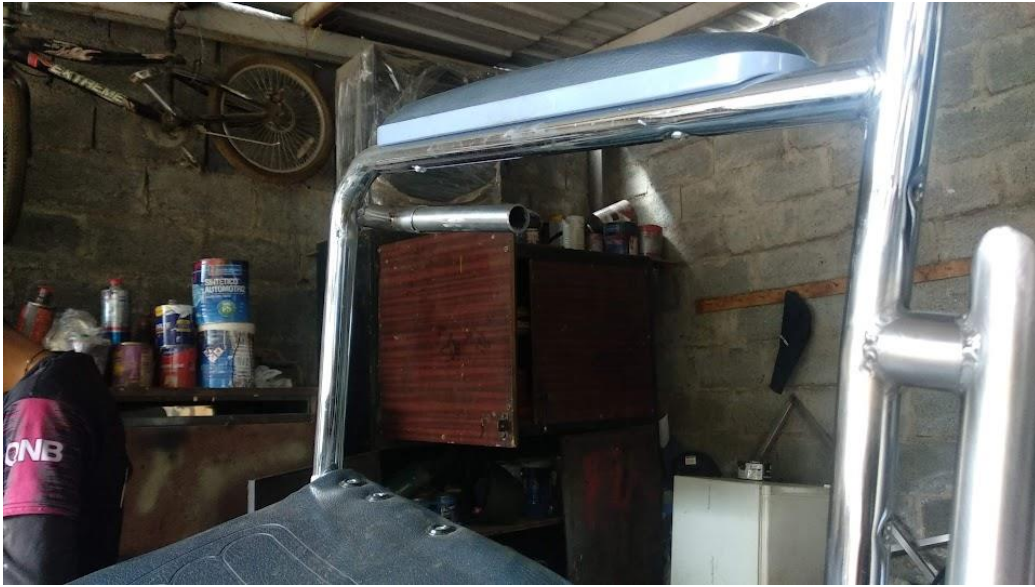
Bases para colocar la palanca de mando, freno y display
