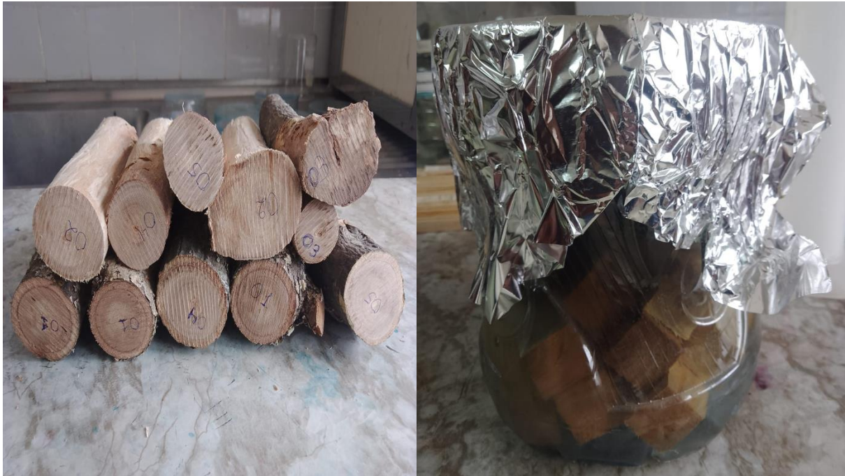
6.1 Preparación de las probetas en agua y alcohol por 24 horas
