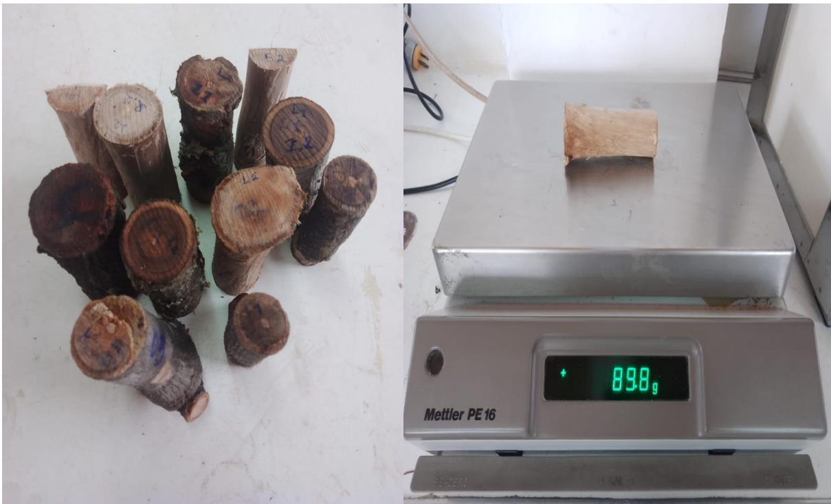
6.2 Secado y toma de pesos de cada una de las probetas obtenidas
