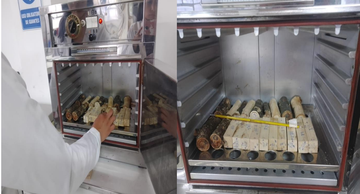
6.3 Ubicación de las probetas dentro de una estufa a 100°C para su respectivo secado
