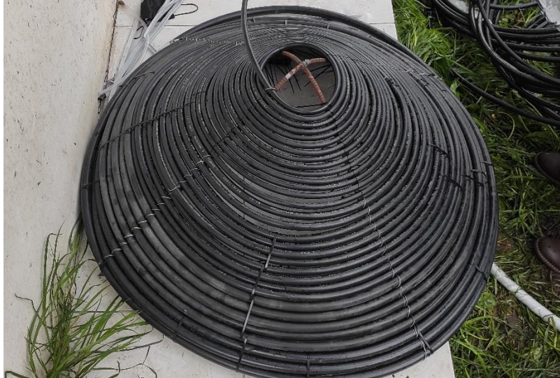
Figura 29. Experimentación con el diámetro de manguera del colector.
