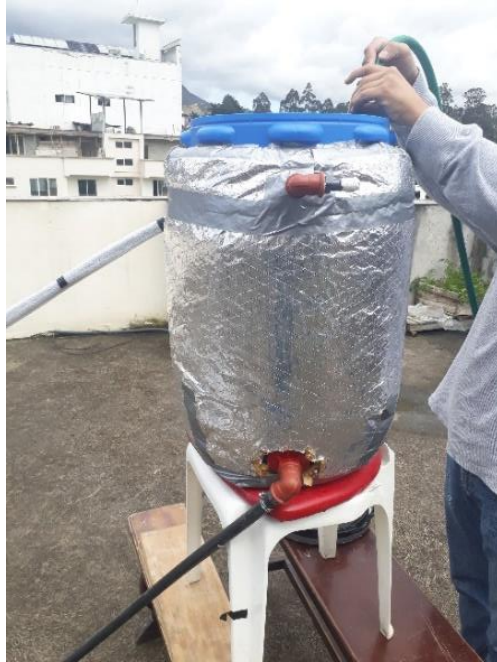
Figura 18. Termotanque herméticamente aislado.
