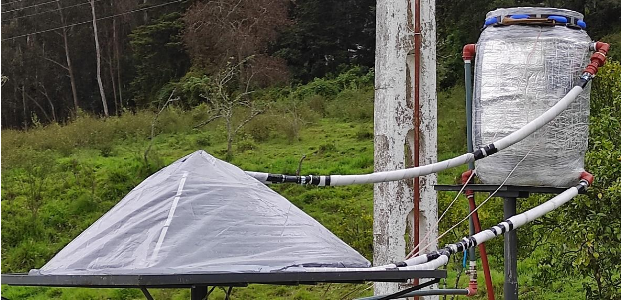
Figura 28. Experimentación en la cubierta del colector.
