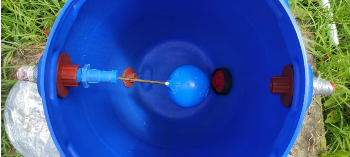
Figura 45. Tanque auto llenado por flotador.
