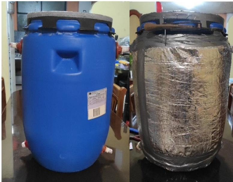
Figura 27. Experimentación en el aislamiento térmico en el termotanque.
