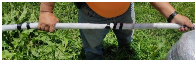
Figura 26. Experimentación en el aislamiento térmico de las tuberías.
