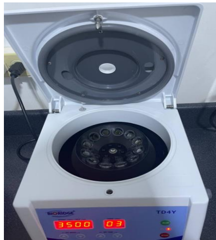
Figura 2. Centrifugación de las muestras a 3500rpm durante 3 minutos
