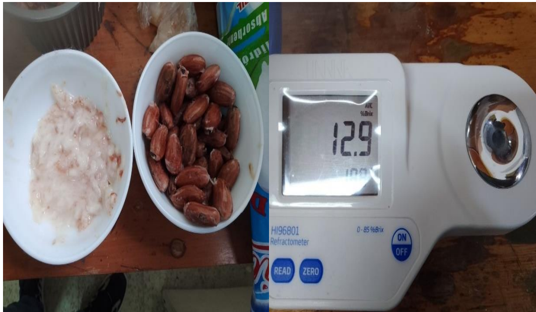
Anexo 1, figura 7. Almendra y mucilago cálculo de Brix del Caco Clon ETPP 801
