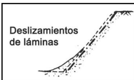
**Figura 17.** Deslizamiento traslacional de láminas.
