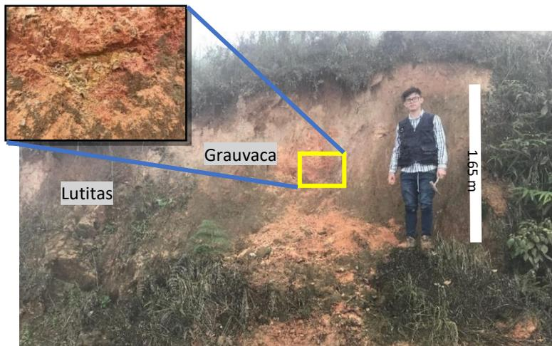
**Figura 53.** Afloramiento de grauvaca con lutita
