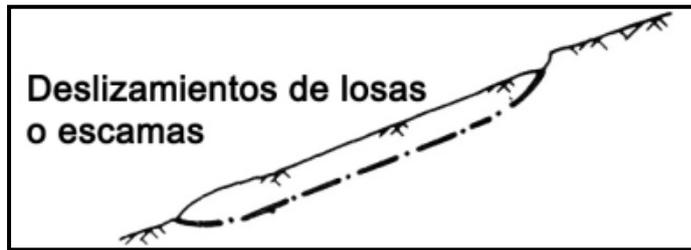
Figura 18. Deslizamiento traslacional de losas o escamas
