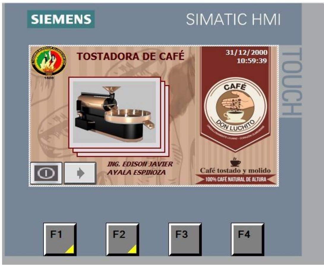
Figura 69. Pantalla principal para el control y monitoreo del proceso de tostado de café.
