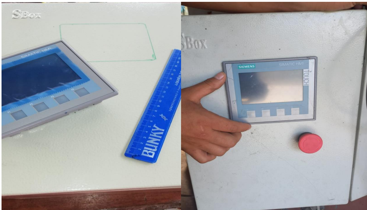
Figura 75. Instalación de la pantalla HMI
