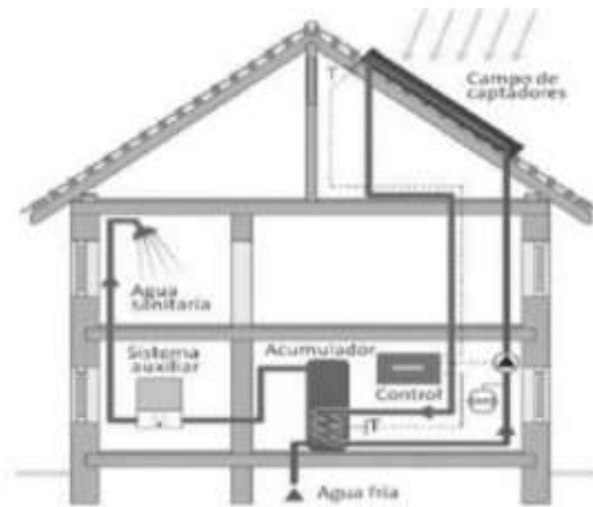
Figura 2. Instalación de energía solar térmica (Martínez, 2010).
