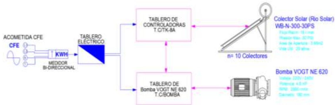
Figura 51. Esquema del tablero general de control (El autor).
